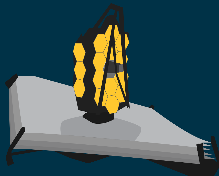
Tensionado y separación de las cinco capas aislantes del parasol
