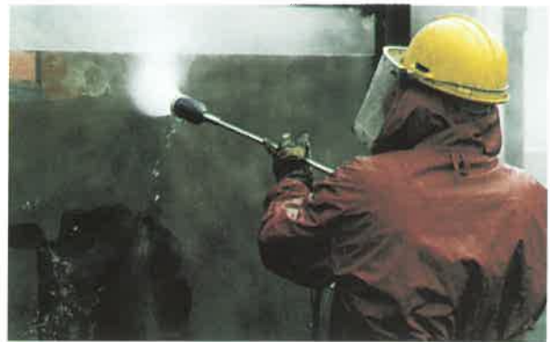
Pistolas de alta presión con cabeza porta-tobera rotativa modelo TD 2100 para decapado de superficies metálicas
