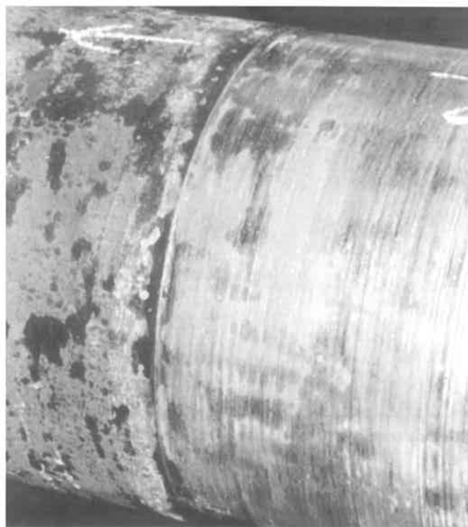
Daños en la camisa de proa del eje de cola
