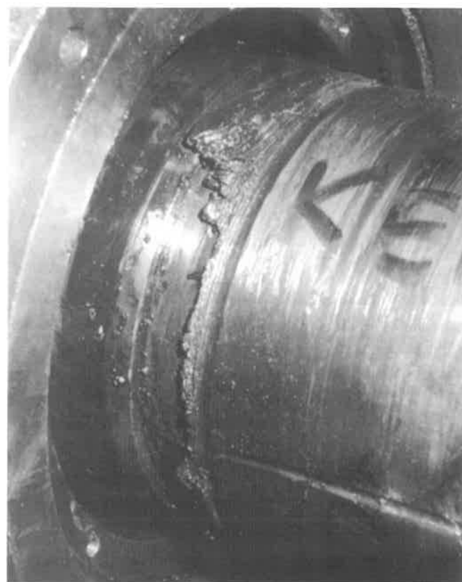
Eje de acero inoxidable con la camisa gripada
