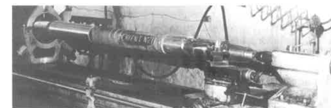
Reconocimiento del acero de un eje por fallo del material de la camisa
