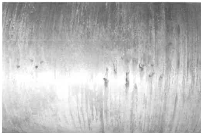
Poros en una camisa de bronce de un eje de acero al carbono
