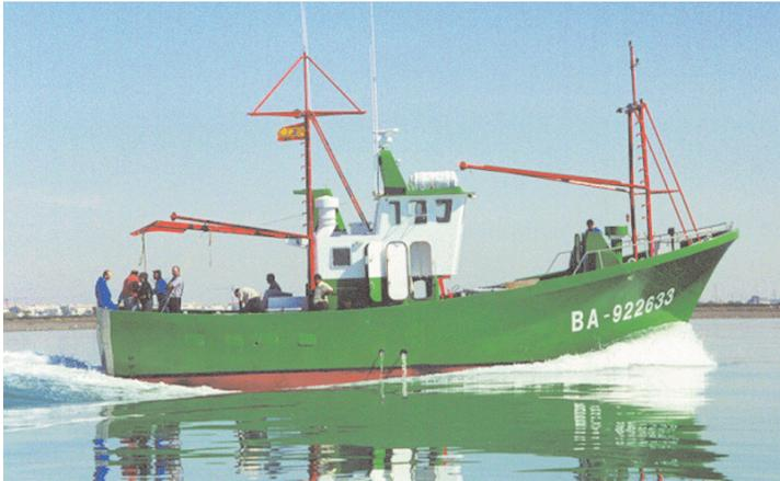
Clasificación. La cubierta tiene un arrufo importante a proa y una brusa parabólica de 100 mm de flecha máxima.
