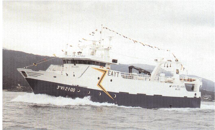
**El buque ha alcanzado una velocidad en pruebas de 12,2 nudos, gracias a sus 470 CV de potencia propulsora**
