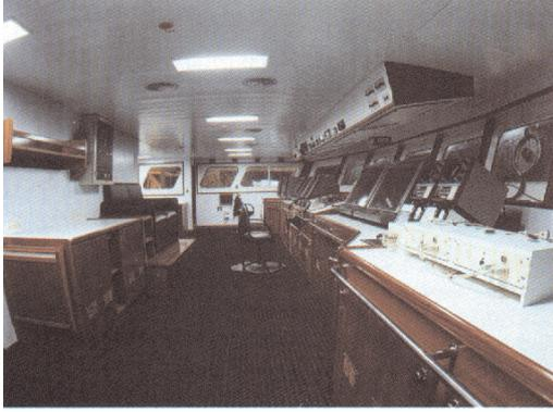
**El Montelucia posee dos unidades de transmisión para los repetidores, dos pilotos automáticos, un indicador de ángulos del timón de tipo panorámico y otros tres para empotramiento en mamparo**
