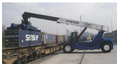
Fig. 4. RS operando en 2ª línea de tren.
