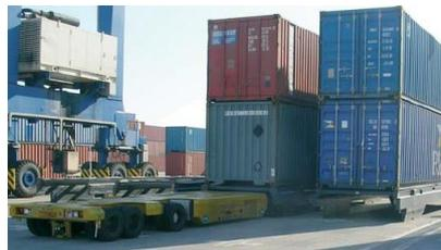
Fig. 12. C-AGV ubicándose debajo de una cassette (plataforma) cargada.
