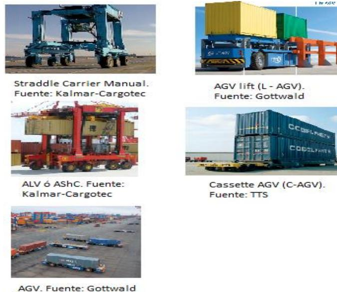
Fig.5. Comparación de sistemas de Transporte Horizontal para terminales automatizadas.
