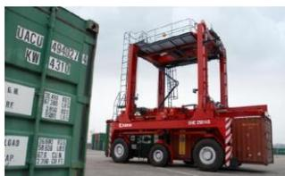
Fig. 4. ALV de la casa Kalmar (AShC) transportando un contenedor de 40'.
