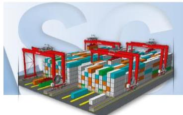
Fig. 8. Grúas ASC Configuración de dos grúas no pasantes por bloque (configuración Twin).
