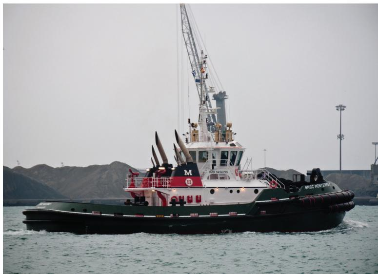
La forma del casco genérica para los remolcadores de la clase RAstar ha sido extensamente probada con modelos para verificar la velocidad, el remolque indirecto, su comportamiento en la mar y sus capacidades de maniobra. SE han diseñado para llevar a cabo operaciones en aguas subtropicales, en condiciones extremas de humedad y calor; temperatura del agua del mar de 32 °C y temperatura ambiente de 35 °C.
