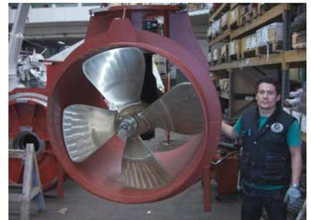
Este propulsor de 45 kW de potencia, se instalará en un buque de pasaje del armador Petrakov, y está diseñada para facilitar las maniobras en puerto y para mejorar la maniobrabilidad del buque.
