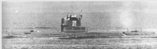
Fig. 28. Un submarino soviético Tipo W navegando. Es bien visible la similitud con las unidades Tipo XXI
