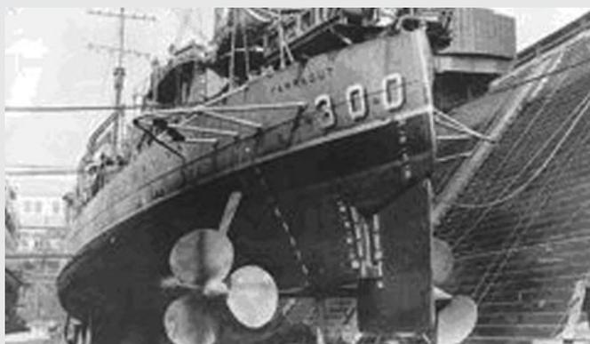
Fig. 8. Detalle de la parte de popa y hélices del DD 300, *USS Farragut*
