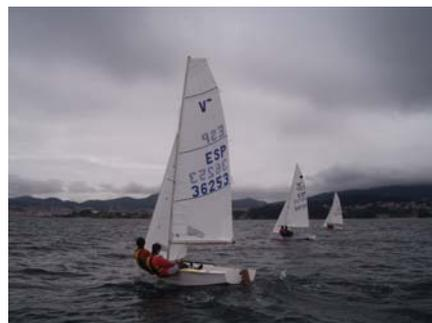
Tiene una eslora de 408 cm, una manga de 147 cm y un peso de 95 kg. En cuanto a las velas, la mayor tiene 5,60 m<sup>2</sup>, el foque 2,50 m<sup>2</sup> y el spinnaker 9 m<sup>2</sup>.
