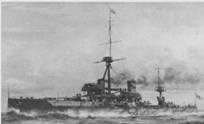
Fig. 1. El *Dreadnought* británico, cabeza de serie de los acorazados monocalibre
