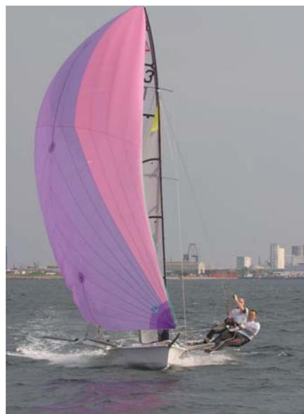
lón mide 1,70 m y el mástil 8,10 m, y el peso se encuentra entre los 62 y los 92 kg. En cuanto a la superficie de las velas, la mayor mide 15 m<sup>2</sup>, el genacker 38 m<sup>2</sup> (spi asimétrico) y el foque 6,2 m<sup>2</sup>.
