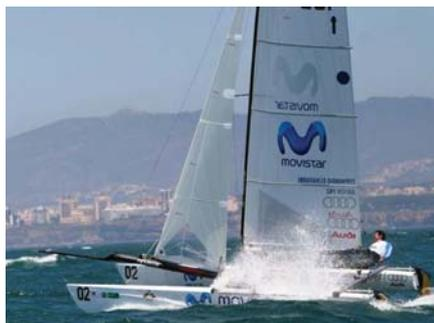
Tiene una eslora de 6,10 m, una manga de 3,05 m, la superficie vélica es de 21,8 m<sup>2</sup> y pesan 140 kg.
