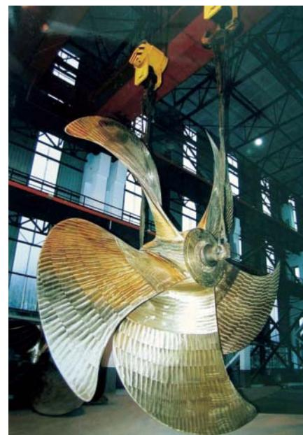
siones permitirán que la fábrica de Zhenjiang suministre en su totalidad los sistemas FPP, las líneas de ejes, bancadas, polines, soportes, chumaceras y sistemas de control para la propulsión del buque. Esta fundición estará en funcionamiento en junio de 2007 permitiendo producir 4.000 toneladas al año y producir sistemas FPP de hasta 140 toneladas.
