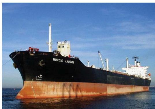
Actualmente el *Nordic Laurita* es un buque con propulsión convencional diesel modelo 6L80GFC de B&W; y se le va a dotar de una propulsión de 4 hélices timón SRP 4040 FP LSV, con una potencia de 3.800 kW a 600 rpm cada uno y con un diámetro de empujador de 4,00 m.
