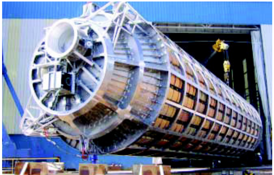
Lanzadera de estructura rígida y cilíndrica, construida de aluminio
