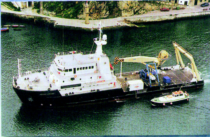
"Adams Nomad" buque ROV/Offshore con posicionamiento dinámico.
