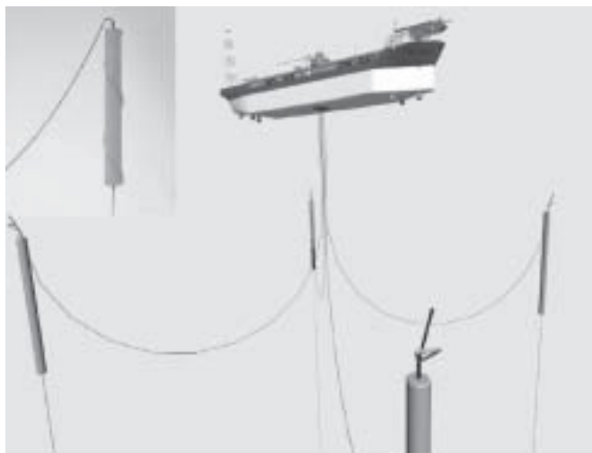
Figura 4.- Esquema del sistema riser para el DP FPSO
