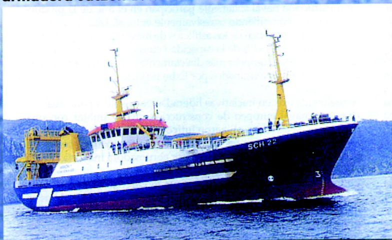
"Wiron 1" y "Wiron 2" Arrastreros congeladores en pareja de 51 metros de eslora para la compañía armadora Jaczon B.V.
