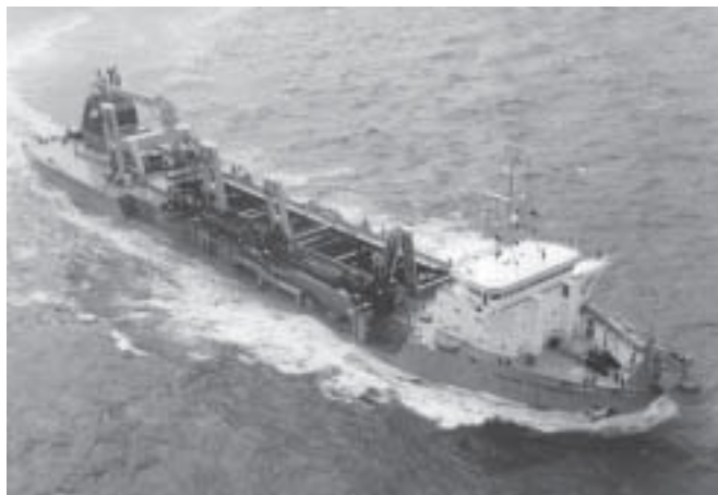
Figura 8.- Draga de succión en marcha
