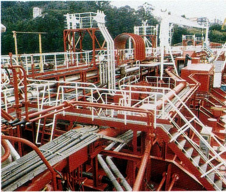
**Vista de los manifolds de carga/descarga**
