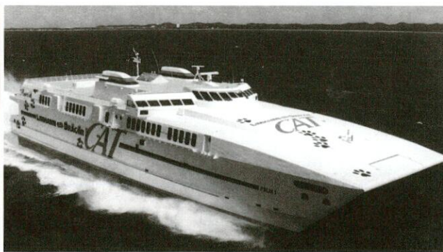
"Felix" the CAT, Catamarán Ferry rápido de 82 metros de eslora para pasajeros y vehiculos diseñado usando Maxsurf y construido por Austal Ships
