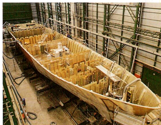
Construcción del casco con PRFV
