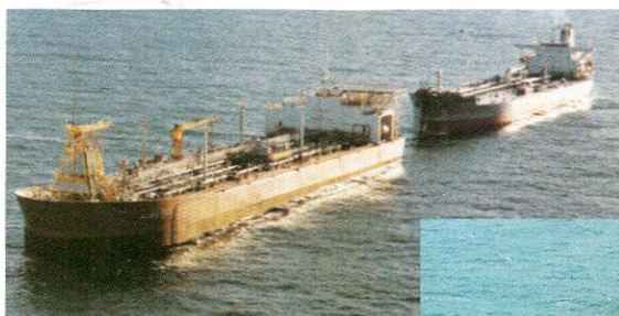
Operación en el Mar del Norte. El Alba FSU traslada el petróleo extraído del fondo del mar a un barco shuttle.
