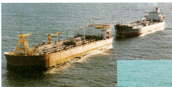
Operación en el Mar del Norte. El Alba FSU traslada el petróleo extraído del fondo del mar a un barco shuttle.
