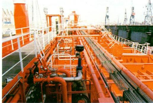
Toda la tubería de carga y todo los elementos en contacto con la carga son de acero 316 L como mínimo.
