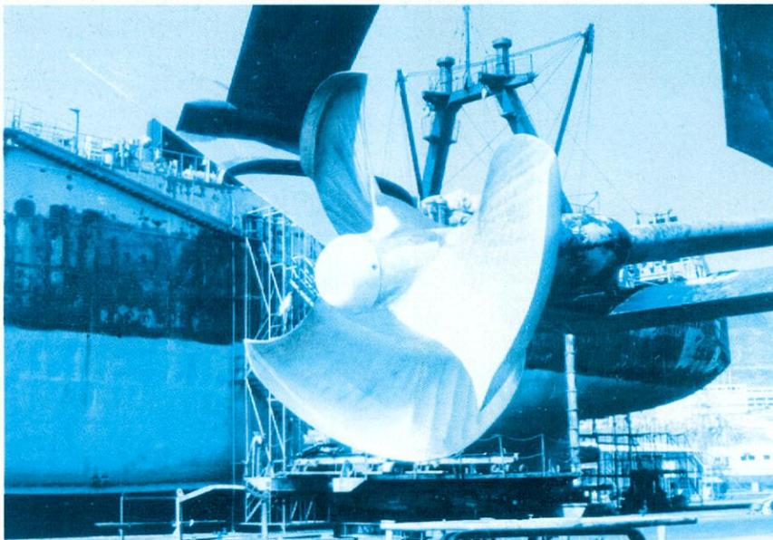
Fotografía de una de las hélices CLT instaladas en el hidroala "Barracuda" de CIA. TRASMEDITERRANEA. Cada hélice absorbe una potencia de 2000CV girando a 986 rpm.
