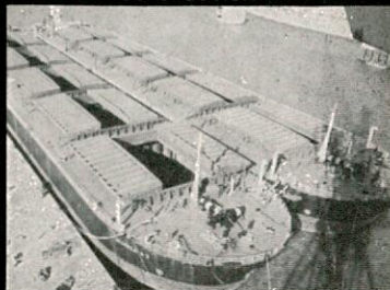
Granelero semi-integrado de 31.000 TPM
