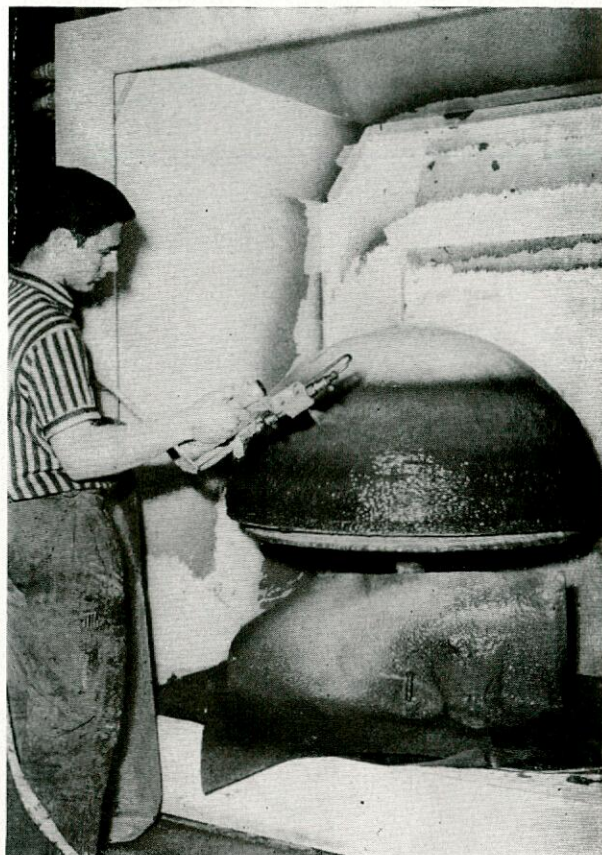
Foto 2.—Obtención de un cuerpo de rotación por el método de pistola.
