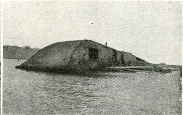
Foto 7.—El buque fué trasladado, tumbado, a menos fondo para adrizarlo después. El buque trasladado, visto en bajamar.
